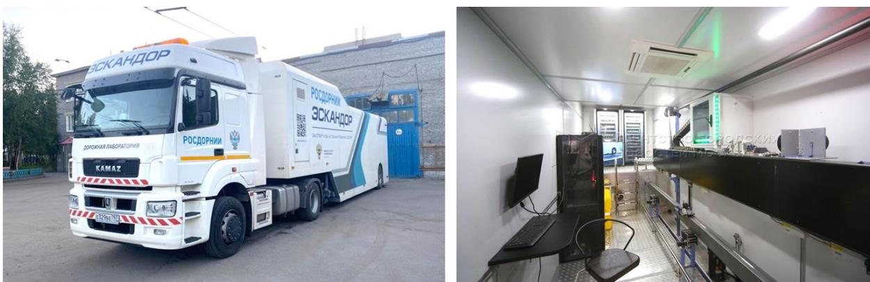
Рисунок 12.3 - Передвижная автолаборатория «Эскандор» проверяет прочность автомобильных дорог в Мурманской области<sup>315</sup>
