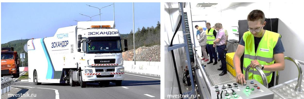
Рисунок 12.6 - Передвижная автолаборатория «Эскандор» проверяет прочность автомобильных дорог в Мурманской области <sup>285</sup>
