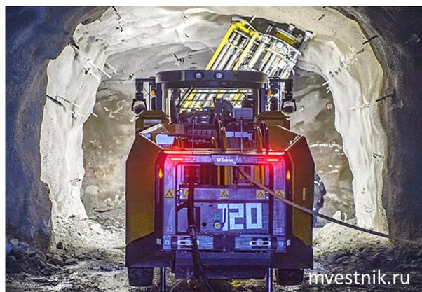
Рисунок 12.3 - На Расвумчоррском руднике АО «Апатит» внедрена технология дистанционного бурения<sup>247</sup>
